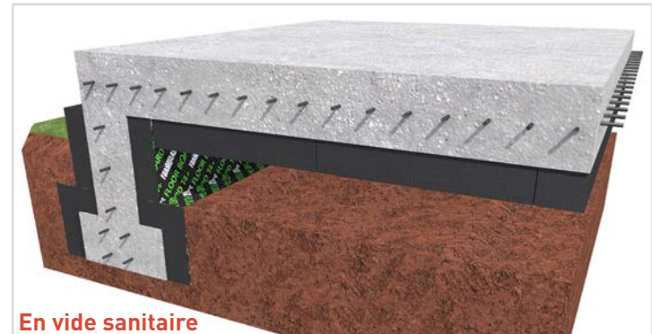
Sous dalle portée
