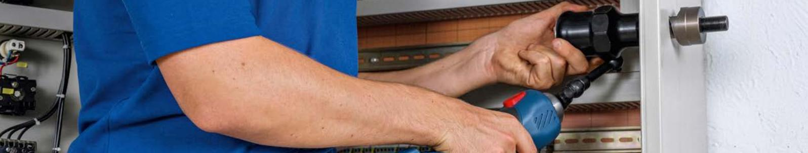
**Ergonomique, compacte et bien équilibrée, la poinçonneuse Bosch offre une bonne prise en main. Avec sa tête rotative à 360°, le travail est facile dans toutes les positions. Grâce à sa prise USB et au logiciel dédié, l'utilisateur visualise l'historique des poinçonnages effectués, les messages d'erreur, les besoins de maintenance et génère des rapports.**
