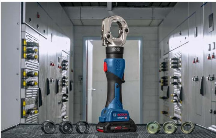
Bosch a également développé des matrices de sertissage pour sertir les cosses sur les câbles allant de 6mm<sup>2</sup>-300mm<sup>2</sup> pour le cuivre et de 10mm<sup>2</sup>-300mm<sup>2</sup> pour l'aluminium. Elles sont compatibles avec les matrices norme NF et DIN (Série E) pour les cosses tubulaires en cuivre. Pour l'aluminium les matrices sont disponibles en norme standard DIN (DIN 46235).
